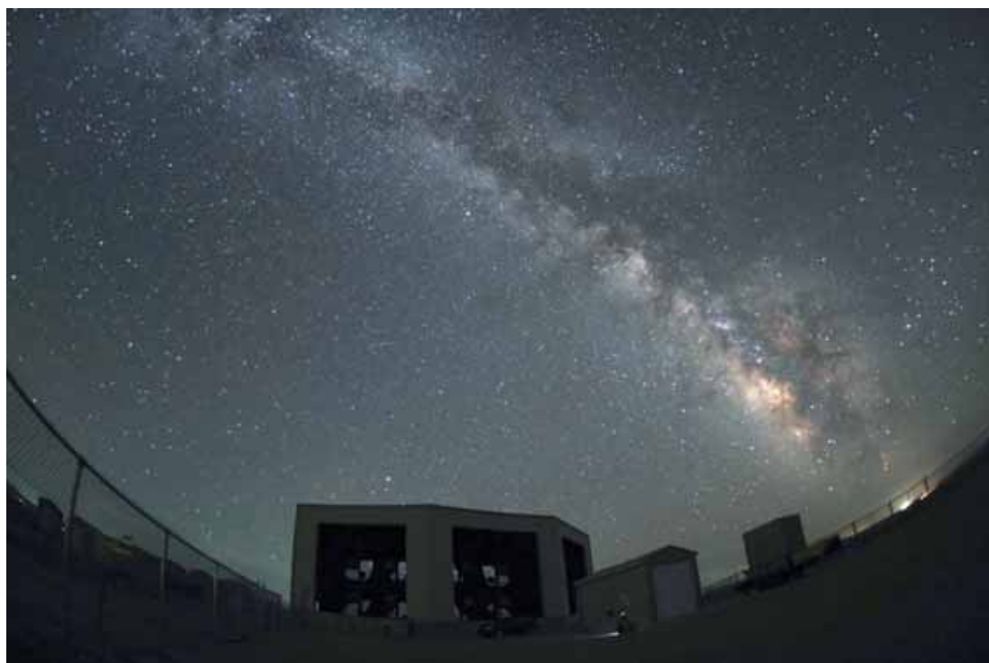
米国ユタ州・デルタ市郊外からのぞむ満点の星空。地上には望遠鏡アレイ実験のサイトBlack Rock Mesaに設置された大気蛍光望遠鏡がある。最高エネルギー宇宙線の空気シャワーから発せられる大気蛍光を捉え、砂漠地域に等間隔に設置された地表粒子検出器（=表紙参照）とのハイブリッド観測を行う
